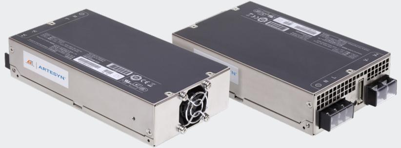
Advanced Energy에서 밀폐형 프론트-엔드 AC-DC 전력 공급장치의 Artesyn LCM300 시리즈는 5개의 단일 아웃풋 모델로 구성되면서 표준 전압의 12V, 15V, 23V, 36V 또는 48V 그리고 5V 예비 아웃풋을 제공합니다. 각 모델은 90 - 264Vac의 범용 인풋을 수용하고, 의료 안정 승인을 구비하고, 91%의 표준 전체 부하 효율성을 갖추고 있습니다. 이러한 PMBus™ 호환 디지털 제어 전원 공급 장치는 특수 배터리 충전 및 관리, 피크 부하 처리, 전압 제어 및 팬 속도 프로파일과 같은 적용별 기능에 대해 높은 수준의 개조 유연성을 제공합니다. 높이 1U 미만의 소형 4x7인치 엔클로저에 내장된 LCM300 전원 공급 장치는 냉각을 위한 내장 스마트 팬을 갖추고 있으며 최대 310W의 출력 전력을 제공할 수 있습니다. 24V 및 36V 모델은 최대 45°C의 작동 온도에서 최대 360W를 공급할 수 있습니다.
